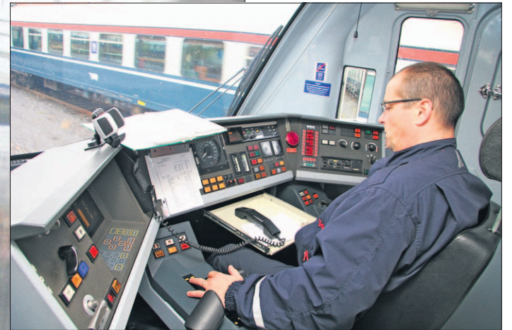
Veturinkuljettaja Jussi Kulmala työpaikallaan. Paineilmaistivisteisillä ovilla varustettu Sr2-tyyppinen veturi on varsin hiljainen työympäristö.
